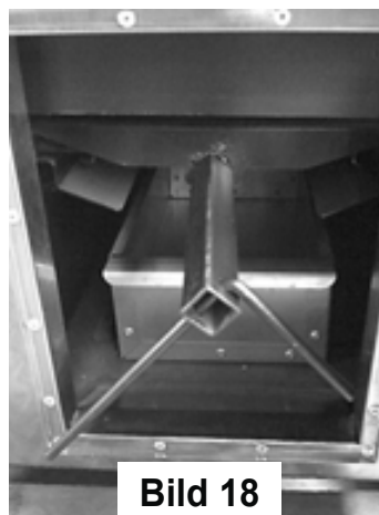
Mechanismus für Einstellung Feuerregime mit Schlüssel für Heben (24)
